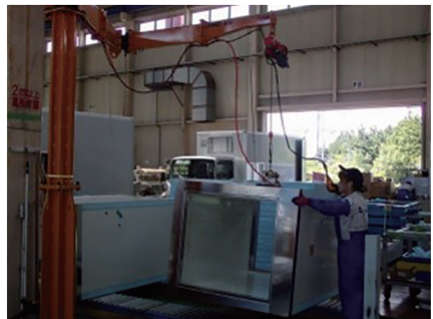
ジブクレーン
